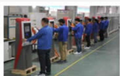
新能源汽车充电桩总装车间
